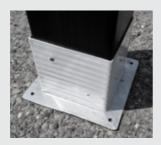
Il basamento è realizzato in acciaio zincato a caldo di spessore 2,5 mm rivestito con pellicola rifrangente ad alta risposta luminosa di classe R2. Il basamento garantisce un solido ancoraggio alla pavimentazione o al plinto di cemento tramite i fori presenti sulla piastra di base. Sono presenti opportune aperture interne per evitare l'accumulo di liquidi dovuti ad eventuali infiltrazioni.
