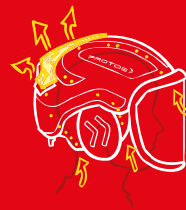
Sistema di ventilazione
